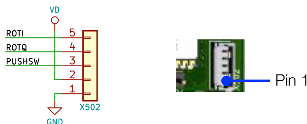
Pinbelegung Drehgeber
